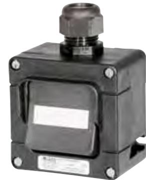
Solutions standards dédiées aux circuits d'éclairage (monophasés 230 V AC). Permet une commande locale en zone ATEX, avec des versions interrupteur MARCHE/ARRÊT ou va-et-vient ou BP à impulsion (pour les circuits avec télérupteur).
