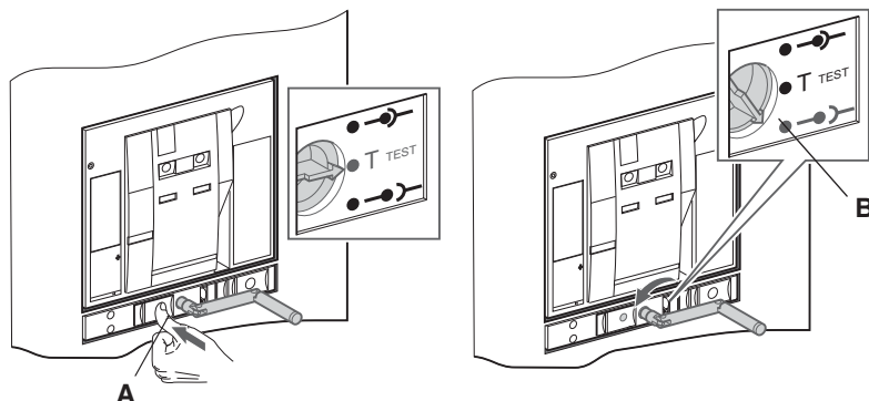
Figure 58 – Debloquer le disjoncteur sur la position déconnectée
