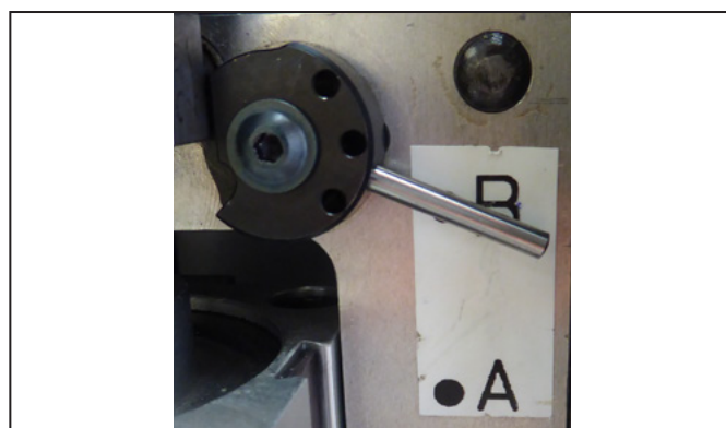
Ilustracja 5.3 Uchwyt mocowania gołego przewodu - konfiguracja (ustawienie: B)
