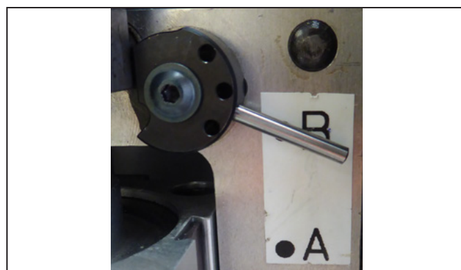
Ilustración 5.3 Configuración de la unidad de soportes de sujeción de los cables trenzados (ajustados en: B)
