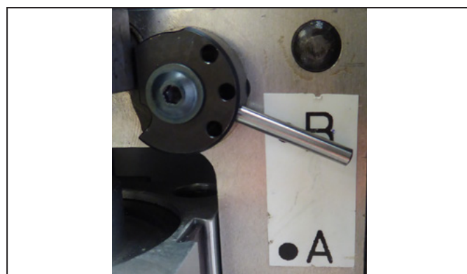
Figura 5.3 Configurazione dell'unità di fissaggio trefoli (impostazione: B)
