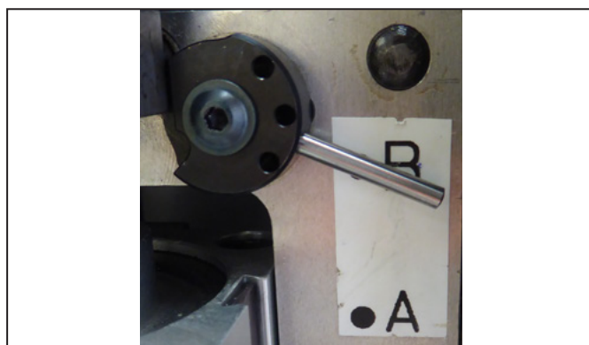
Bild 5.3 Montagehållare för flertrådiga ledare (inställt: B)
