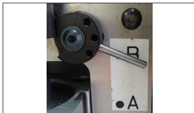
Figure 5.3 Configuration de l'unité de fixation des conducteurs semi-rigides (réglage : B)
