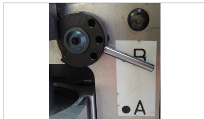
Figure 5.3 Configurarea unității de fixare a cablului torsadat (setare: B)
